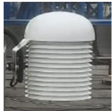
Рисунок 5. Датчик температуры и атмосферного давления в защитном кожухе
