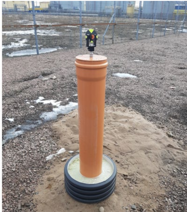
Рисунок 4. Пункты плано-высотного обоснования с призмами обратной засечки
